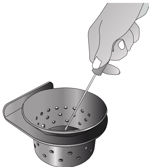
Slika 10: Čišćenje rešetke ložišta
